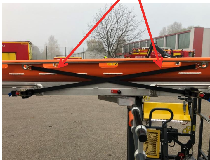
Mise en place du porte brancard sur la colonne multi fonctions
