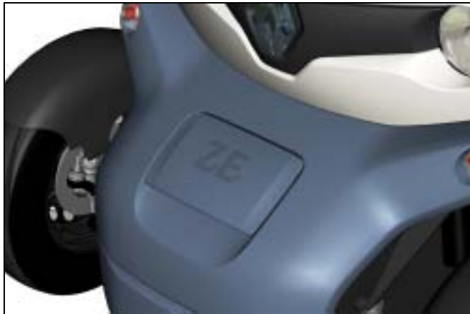
Trappe de charge fermée
