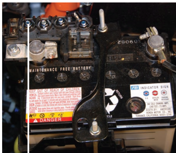
Connexion du câble du convertisseur c.c. à c.c.
