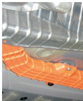
Bouclier haute tension boulonné à la carrosserie
