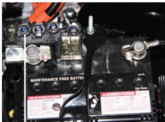
Connexion du câble du convertisseur c.c. à c.c.
