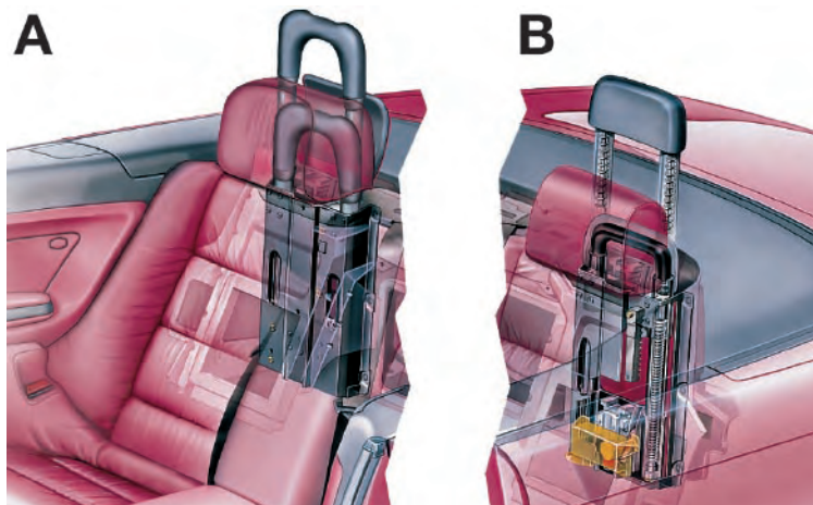
Système de protection au retournement déclenché sur Série 3 E46 (A) et E36 (B) Cabriolet
