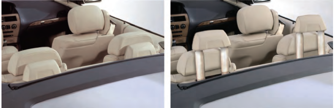
Arceau de sécurité de la Série 6 E64 en position normale et déclenché (à droite)
