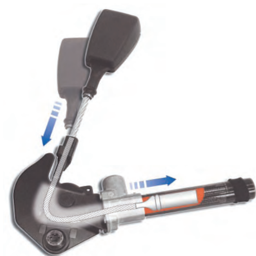
Rétracteur pyrotechnique de ceinture
