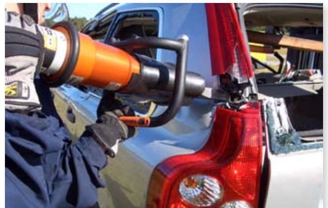
Des coupes pénétrantes s'effectuent facilement avec les cisailles NCT™ II.
