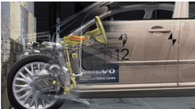
Zone de déformation absorbant l'impact. (A)
