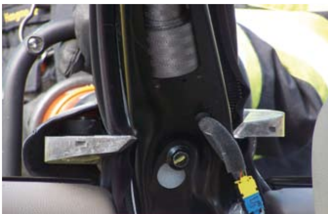
Les cisailles New Car Technology d'Holmatro sont conçues pour pouvoir entourer et découper les montants larges, épais et renforcés des voitures les plus récentes.
