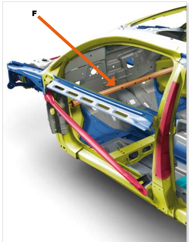
Cellule de sécurité à structure renforcée. (D)
