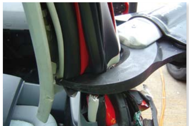
Les matériaux à haute résistance sont poussés dans l'évidement de la cisaille, là où la force de coupe est la plus élevée.
