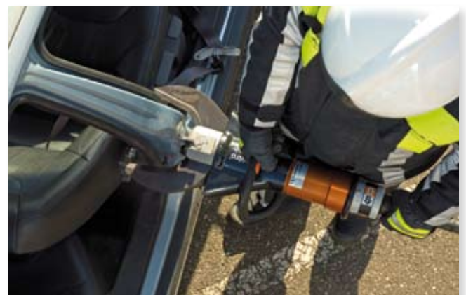
Les cisailles New Car Technology d'Holmatro sont conçues pour pouvoir entourer et découper les montants larges, épais et renforcés des voitures les plus récentes.
