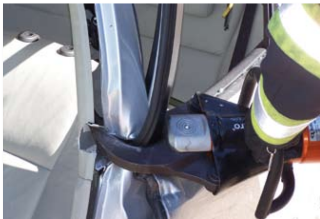
Les matériaux à haute résistance sont poussés dans l'évidement de la cisaille, là où la force de coupe est la plus élevée.
