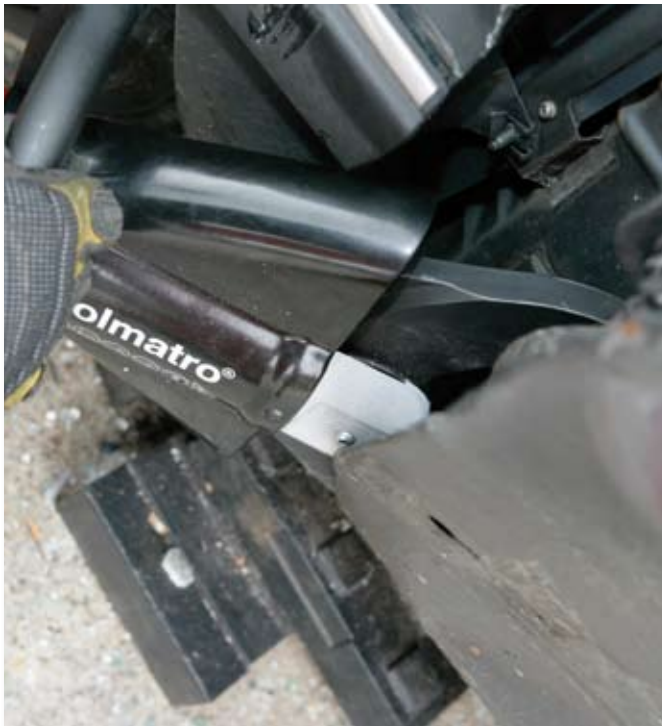
Meilleur accès aux endroits difficiles grâce à la forme plate de l'i-Bolt.
