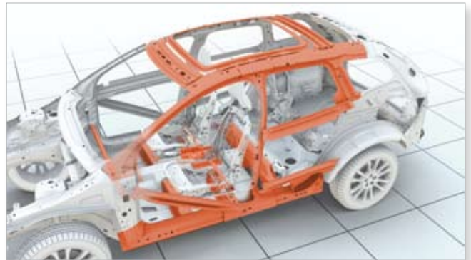
Cellule de sécurité à structure renforcée. (D)
